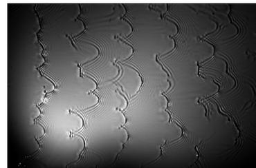
Visualisation de la surface d'un film liquide tombant sur un plan incliné (de la gauche vers la droite) soumis à un contre-écoulement d'air.
