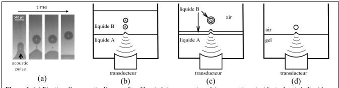
**Figure 1:** (a) Ejection d'une goutte d'une surface libre induite par une impulsion acoustique incidente depuis le liquide. Configurations expérimentales (b) d'émulsification ultrasonore, (c) d'encapsulation, (d) d'éjection de gouttes de gel.
